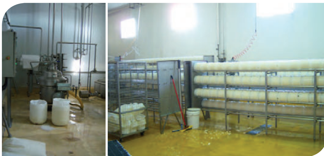
Figura 3. Proceso de eliminación de suero de la cuajada durante la elaboración del queso manchego.
