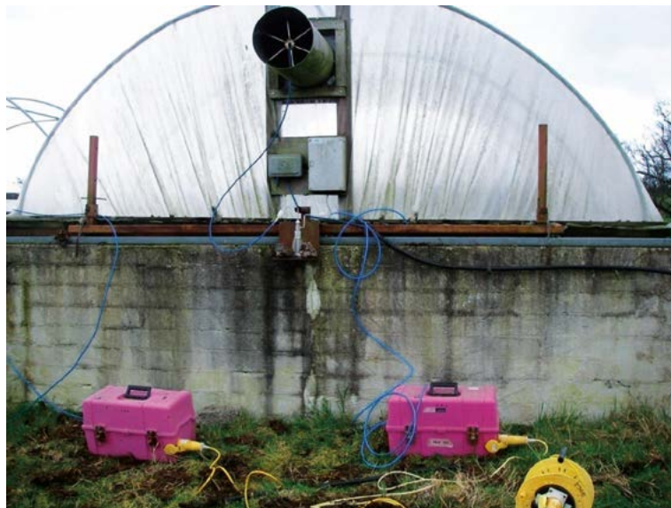
Figura 1. Cámara dinámica para medir emisión de amoníaco en pilas de compostaje. Rothamsted research, North Wyke, Okehampton, Devon, Reino Unido. Fuente: Velasco-Velasco et al. (2011).
