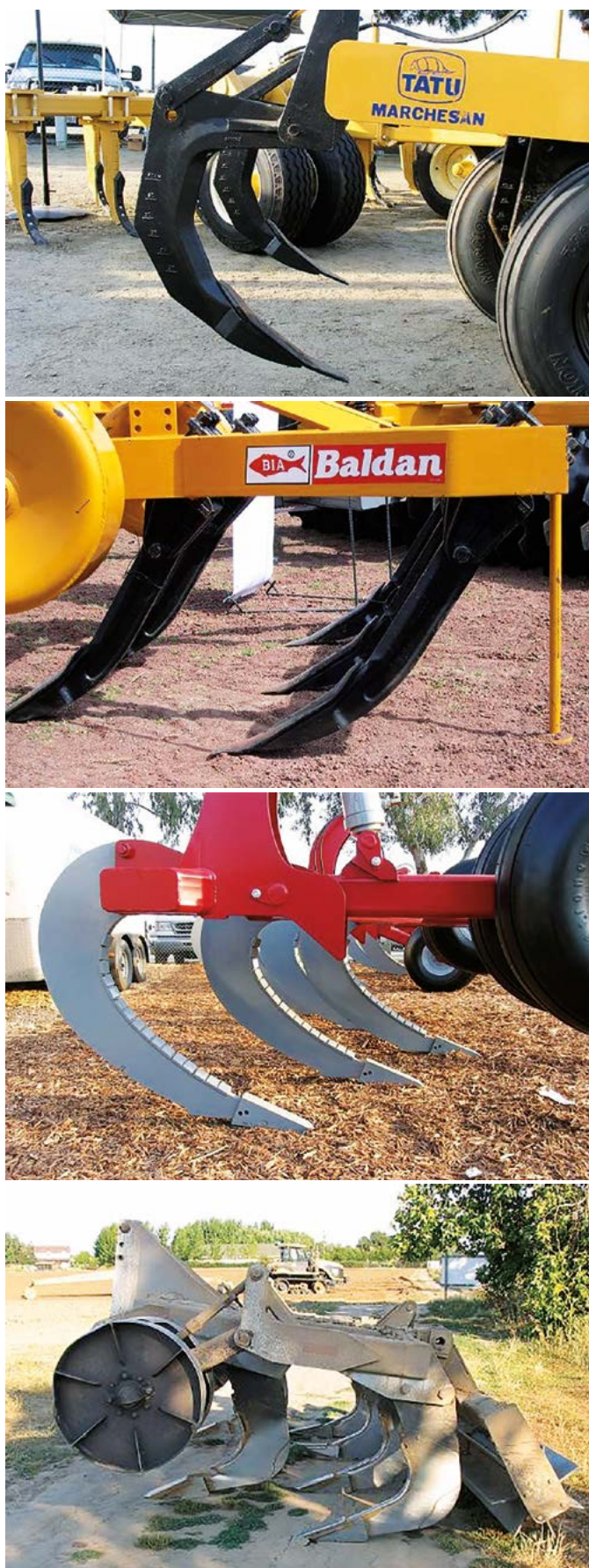
Figura 4. Herramientas de labranza del tipo de arrastre con diferentes configuraciones de diseño.
