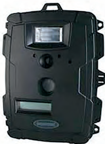
Figura 1. Cámara equipada con luz infrarroja y sensible al movimiento
