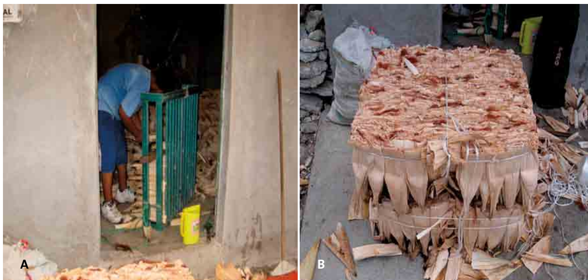
Figura 6. A: molde para las hojas de maíz; B: vista frontal de dos pacas de hojas.
