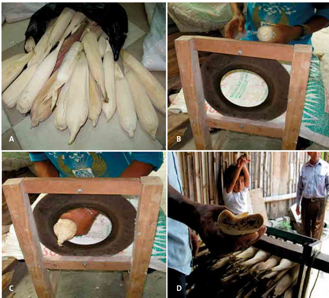
Figura 5. A: Mazorcas seleccionadas; B: Disco de metal en forma de navaja; C: Posición de la mazorca sobre el disco; D: Hojas separadas de la mazorca.
