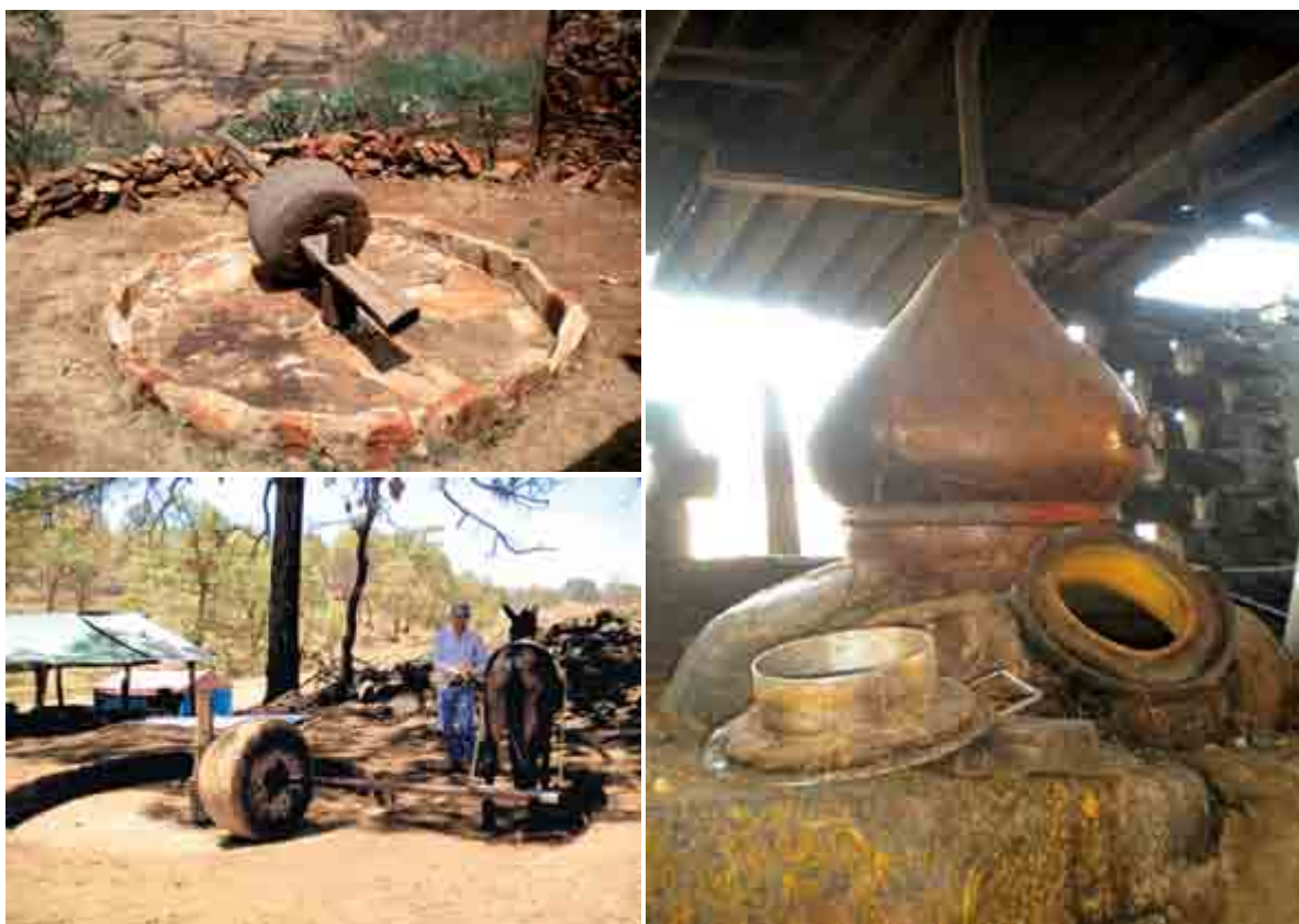
Figura 3. Tahona o molino de piedra y alambique de cobre, empleado en el proceso de destilación de tequila a partir de Agave tequilana Weber.
