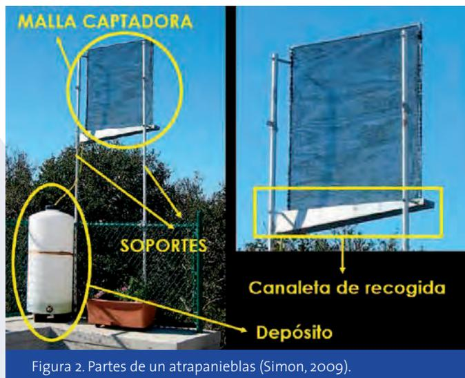
Figura 2. Partes de un atrapanieblas (Simon, 2009).
