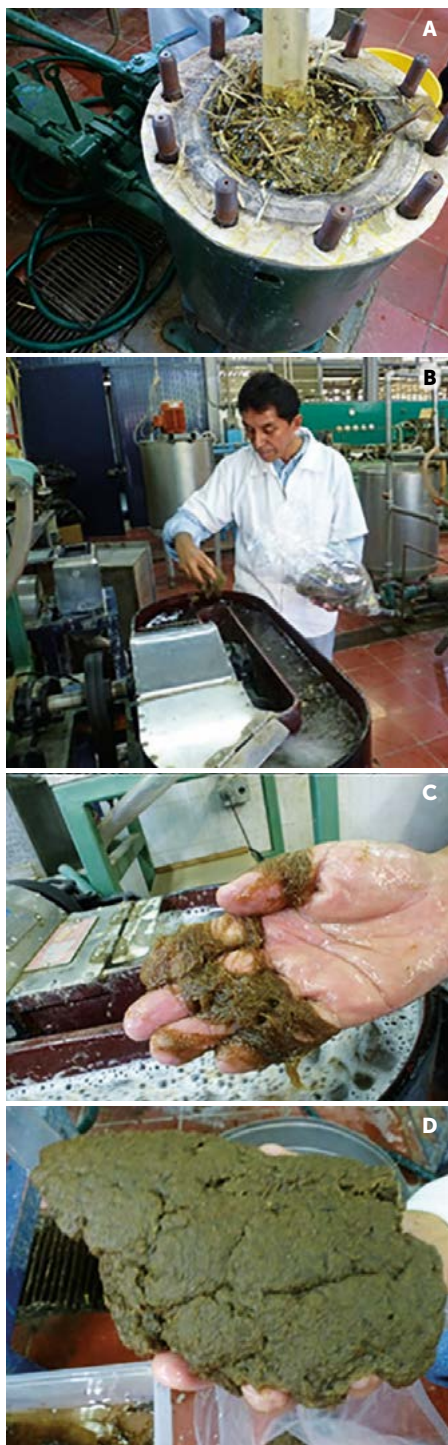
Figura 2. Proceso de elaboración de fibras de celulosa. A: Llenado del digestor con paja, NaOH y agua. B: Paso de la fibra en la pila holandesa. C: Desfibrilado de la paja a los 15 min. D: Calidad de la fibra de celulosa.
