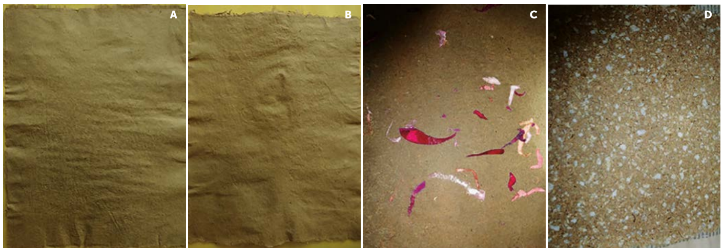
Figura 6. Hojas de papel elaboradas con fibra de celulosa. A: Fibra de celulosa natural. B: Fibra de celulosa más aditivo. C: Fibra de celulosa con pétalos de flores; y D: Fibra de celulosa mezclado con papel reciclado.
